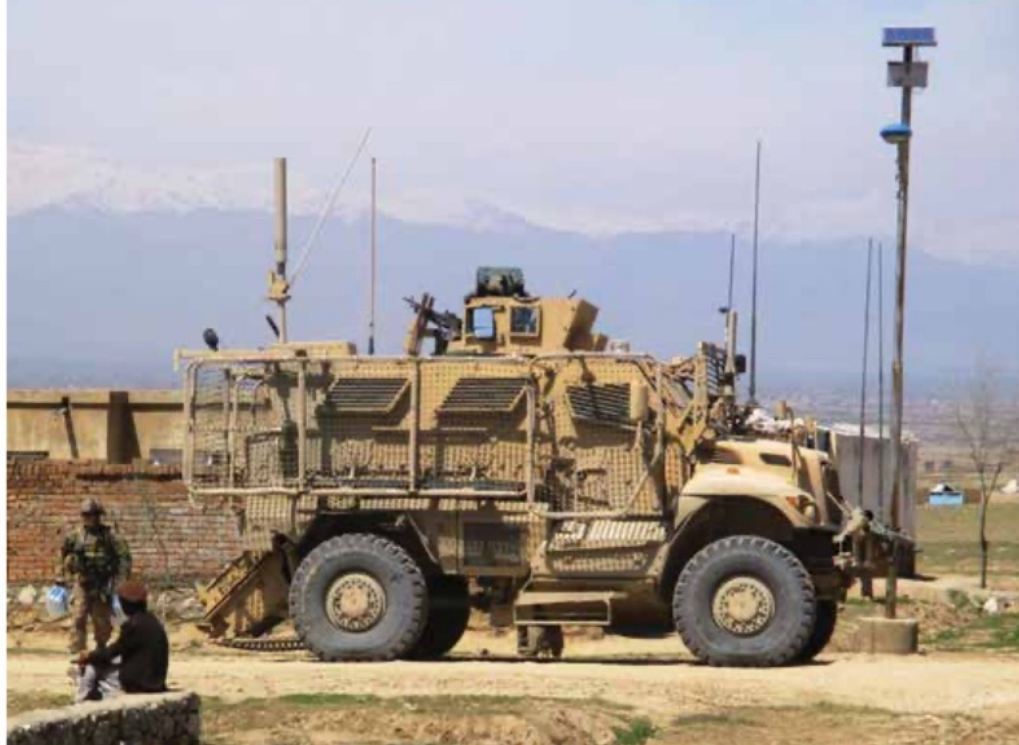
De bemanning van deze Deense MaxxPro heeft de IED-explosie overleefd, waaruit blijkt dat de beschermende cabine goed werkt.
