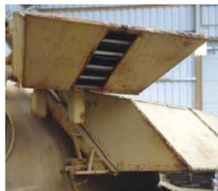
De extra bepantsering van de Irakese T-55 „Enigma” bestaat ook uit aparte platen, zoals te zien is in het opengezaagde blok. Of deze ook geveerd opgehangen zijn is onbekend. (staat in The Tank Museum, Bovington).
