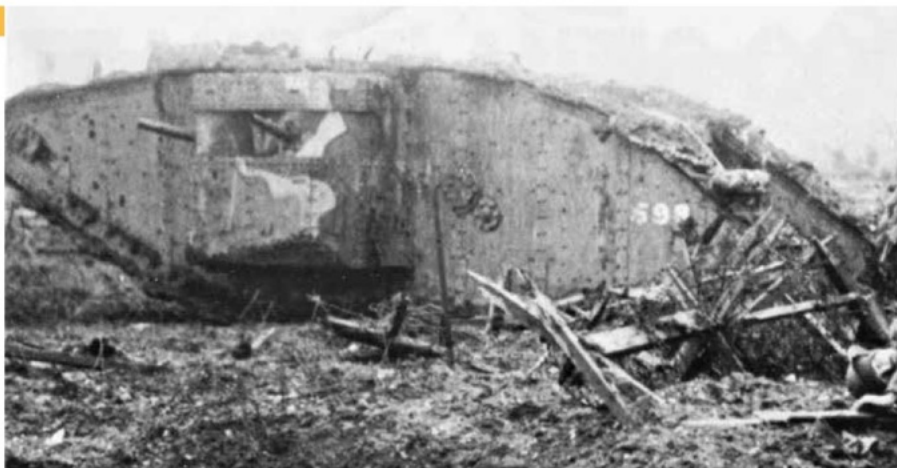
Een Mk.II female, gefotografeerd ten tijde van de strijd om Arras. De gecamoufleerde sponson doet veronderstellen dat hij eerst op een Mk.I zat, maar hij is bewapend met Lewis mitrailleurs in plaats van de oorspronkelijke Vickers machinegeweren.
