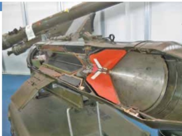
De binnenkant van een Hóng Jiàn-73, de Chinese versie van de Russische 9M14 Malyutka (NAVO-naam: AT-3 Sagger). De springlading is het rode deel, de holte en de metalen kegel ervoor zijn duidelijk te zien. (Foto: Ryo Chijiwa, CC BY 2.0)
