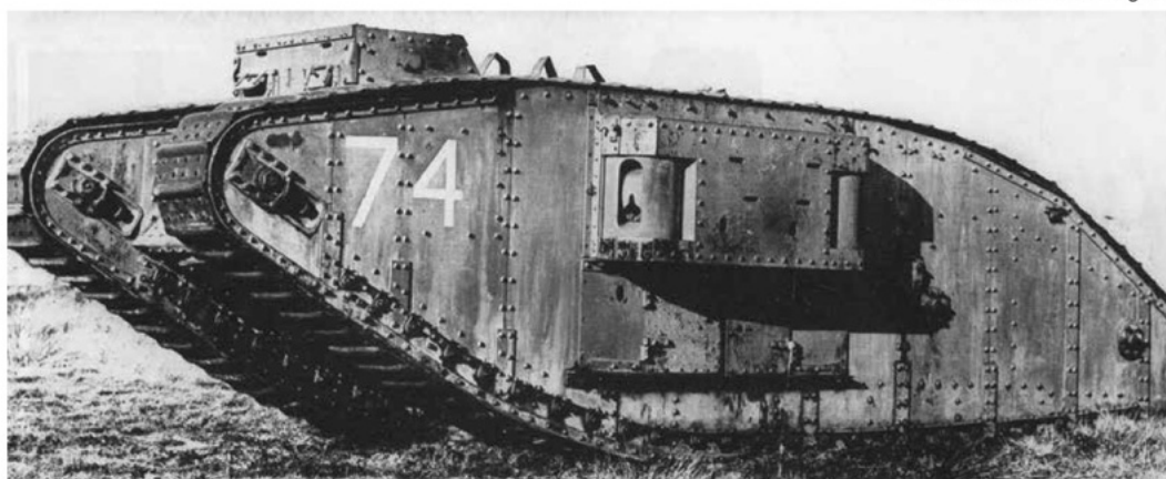
Een Mk.III female met de kleinere Lewis sponsons, gefotografeerd in het oorspronkelijke open lucht Tank Museum in Bovington.
