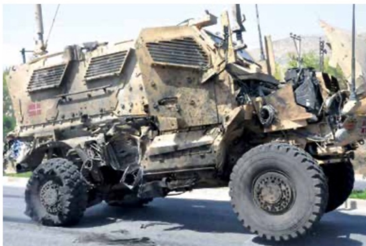
De bemanning van deze Deense MaxxPro heeft de IED-explosie overleefd, waaruit blijkt dat de beschermende cabine goed werkt.
