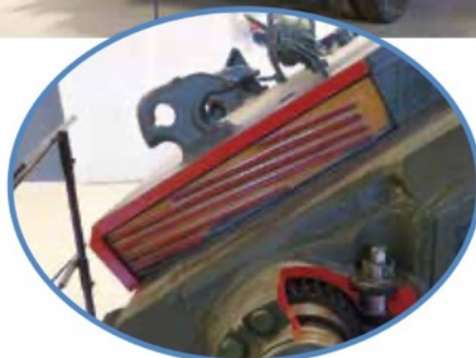
Deze Opeengezaagde T-55 staat in het Panzermuseum te Munster (D). Voorop is de pantseropbouw te zien.
